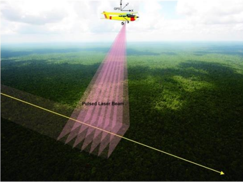
Light Detection and Ranging (LiDAR) maakt gebruik van een gepulseerde laser om gedetailleerde 3D-informatie te krijgen over de vorm en hoogte van het aardoppervlak en de vegetatie. Over het algemeen zijn deze data niet beschikbaar in Indonesië en zijn ze hard nodig voor veengrondmanagement.
